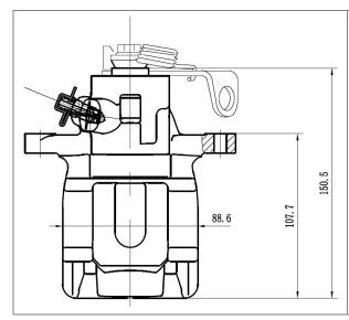
Суппорт тормозной для автомобилей Citroen C3 (02-)/C2 (03-)/Peugeot 207 (06-) задний правый d=38мм
